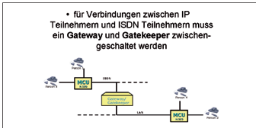
Abbildung 6: Gatekeeper und Gateway zwischen ISDN und LAN
